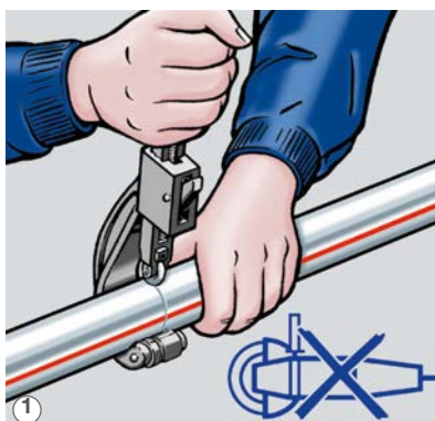
① Kapa det mantlade Prestabo-röret vinkelrätt.
